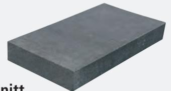
Beim Schärfen wird einige Male (5–6 mal) unter leichtem Druck im Trockenschnitt in den Schärfstein/-platte eingeschnitten/eingetaucht. Ist diese erste Frequenz beendet, wird eine zweite Frequenz gestartet: Schneiden Sie weitere 5–6 mal mit leichtem Druck in den Schärfstein/-platte ein und schalten dabei die Maschine aus bis das Diamantsägeblatt im Schärfstein/-platte zum Stillstand kommt.
