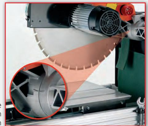
Markierung für die schnelle Durchführung von 2-Stufenschnitten
